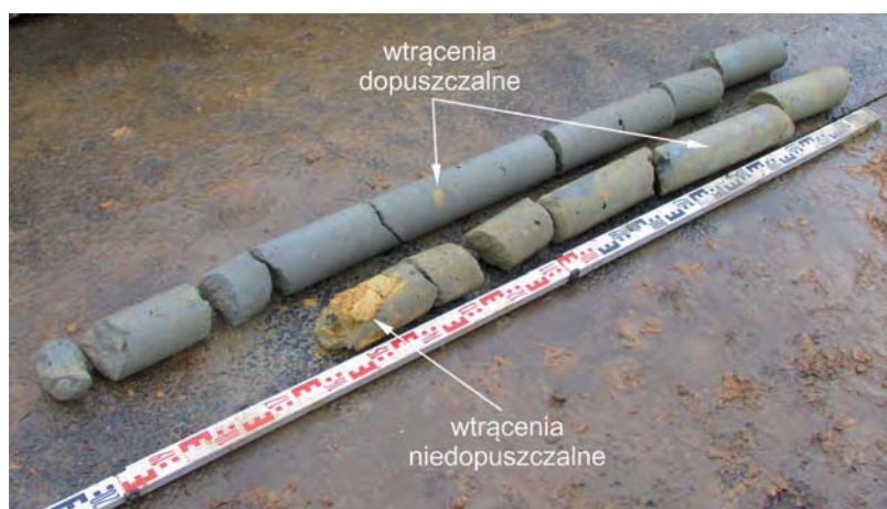
Rys. 5.9. Rdzeń pobrany z kolumny DSM
